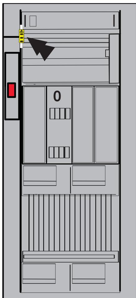
Assurez-vous que les étiquettes indiquant la tension (>200 V) sont en place et qu'elles sont lisibles sur les dispositifs installés.
