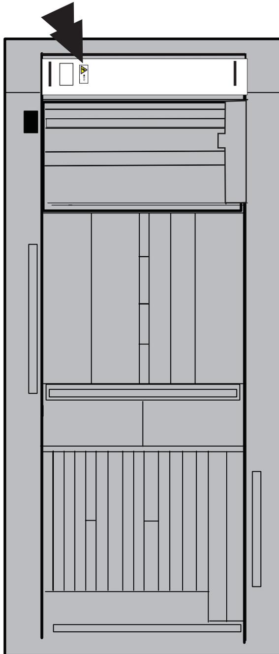
Assurez-vous que l'étiquette indiquant le poids (>32 kg) est en place et qu'elle est lisible une fois le dispositif installé.
