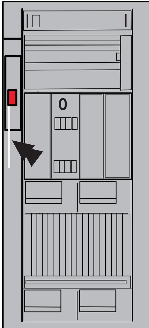
Assurez-vous que l'étiquette indiquant la tension (>240 VA) est en place et qu'elle est lisible sur les dispositifs installés.
