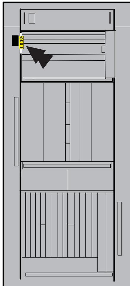
Assurez-vous que l'étiquette indiquant la tension (>200 V) est en place et qu'elle est lisible sur les dispositifs installés.
