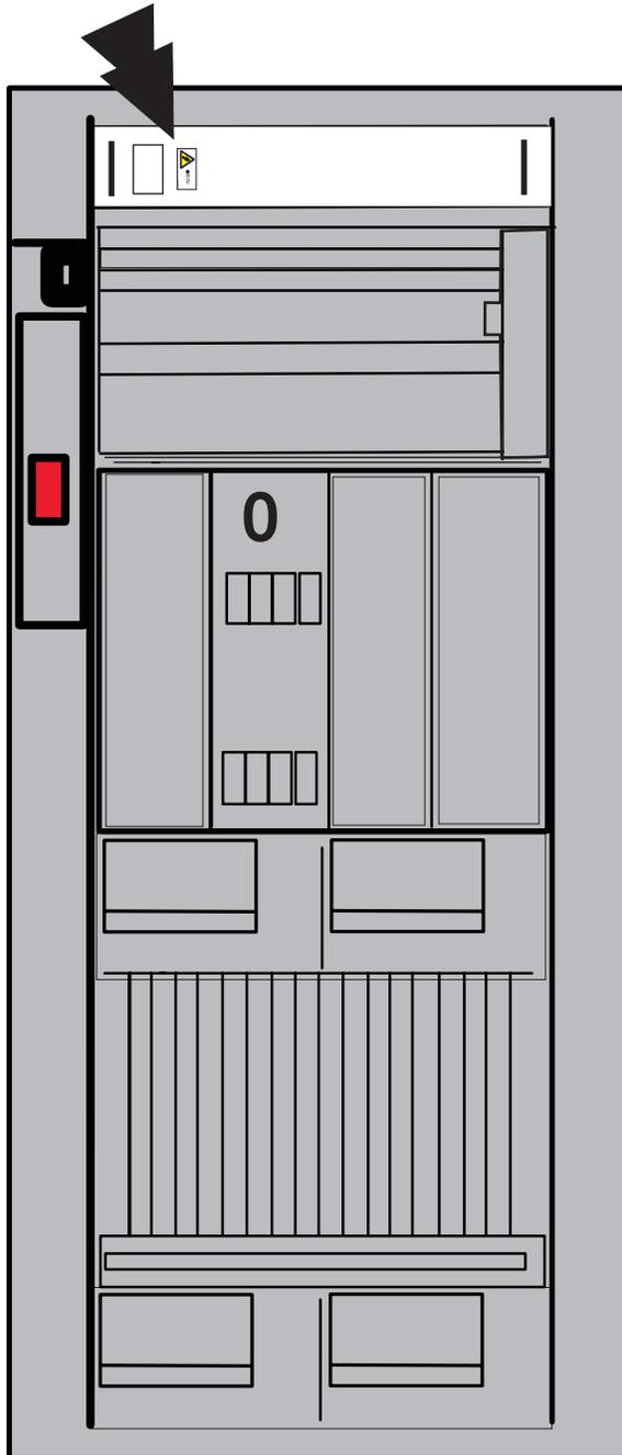
Assurez-vous que les étiquettes indiquant le poids (>32 kg) sont en place et qu'elles sont lisibles une fois le dispositif installé.
